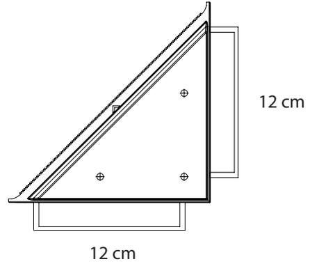
Il Kit di fissaggio biadesivo regolabile comprende due placche dentate in ABS dotate di biadesivo,
