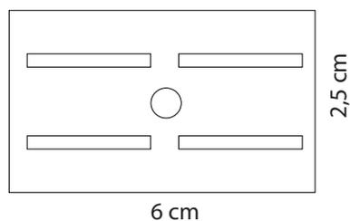
Il Kit di fissaggio biadesivo regolabile comprende due placche in policarbonato dotate di biadesivo e due viti con tasselli per una tenuta ancora maggiore.
